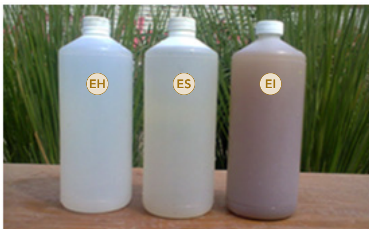
Figura 6: Turbiedad observada en las muestras de agua de la entrada del sistema (EI), salida del sedimentador (ES) y salida del humedal vertical (EH) (Fuente: Alexandra Garcia)
