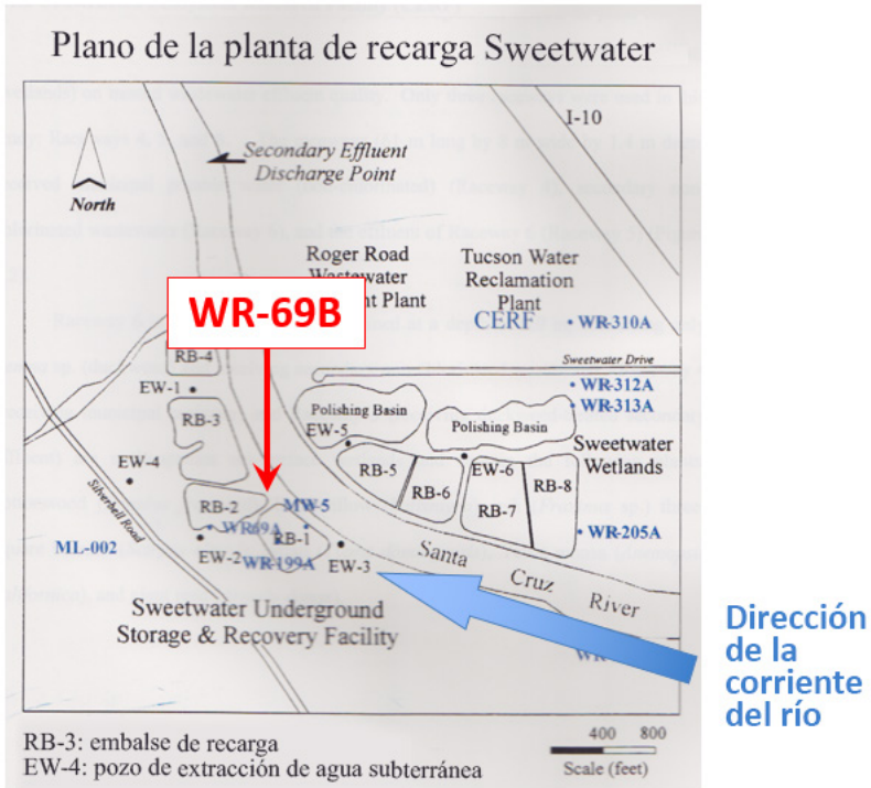
Figura 2: Instalación de recarga Sweetwater en Tucson (AZ), contigua a la planta de tratamiento de aguas residuales de Roger Road (Drewes y colaboradores 2015)
