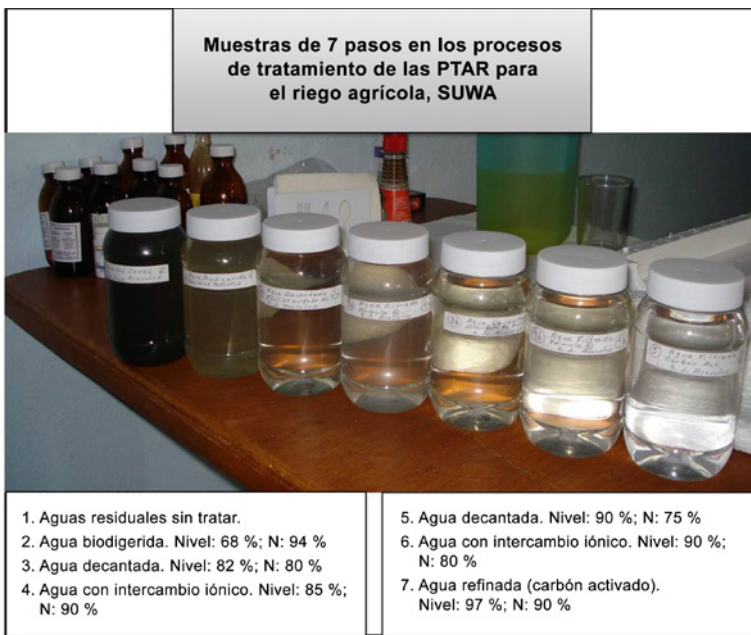
Figura 7: Muestras de 7 pasos en los procesos de tratamiento de las PTAR para el riego agrícola, SUWA
