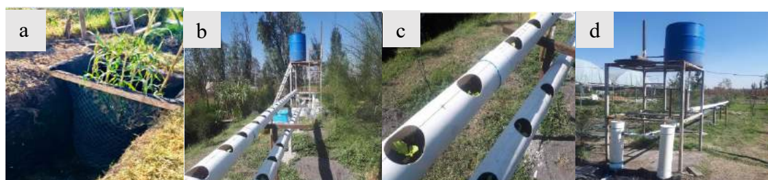
Figura 1. Sistema de biofiltros y sistema de hidroponía NFT. Biofiltro secundario (a); sistema de filtración con grava (b); cultivo de adsorción de E. coli (c); sistema de filtración de corcho funcionalizado con MoSe (d).
