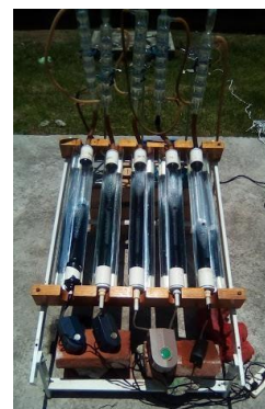
Figura. 1 Colector solar con muestras de agua residual
