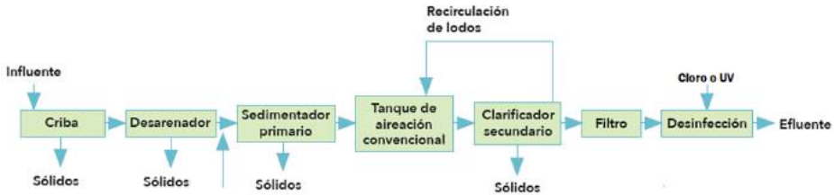
Figura 2. Esquema de las etapas de una PTAR convencional (Noyola y col., 2013).
