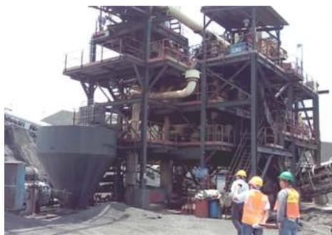
Las operaciones unitarias son: trituración, tamizado o clasificación por tamaño, lavado, secado y mezcla de carbones. De todas estas operaciones solo el lavado genera un vertimiento: “este se realiza con el fin de disminuir el porcentaje de cenizas e impurezas para minimizar los impactos ambientales negativos asociados con la combustión del carbón. El proceso puede ser en húmedo, según tamaño y forma, o en seco, según las diferencias en densidad y fricción” (MME, *et al.* 2015b).
