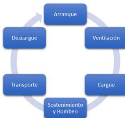
Figura 8. Etapas de la explotación de oro aluvial en los sedimentos del río (MME, *et al.* 2015a)
