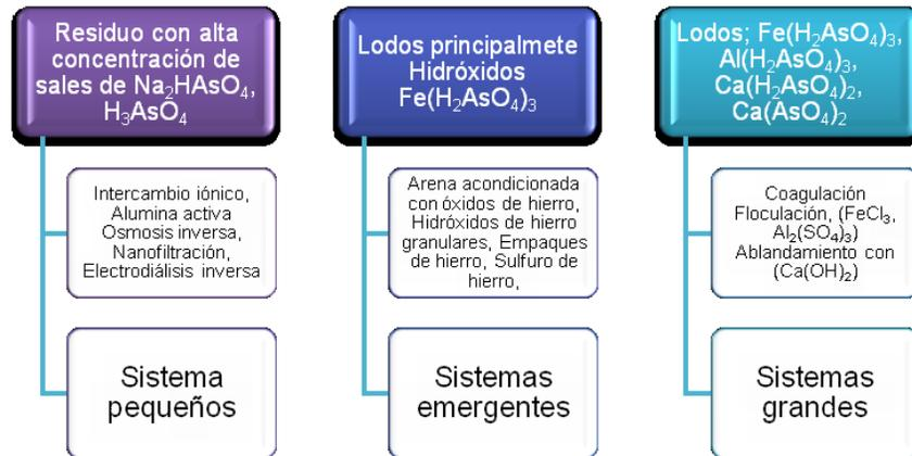
Figura 23. Esquematización de tratamientos de remoción de Arsénico y posibles residuos
