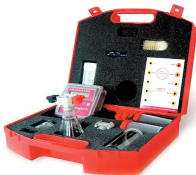
Figura 27. Método no convencional para la cuantificación de arsénico de la marca Wagtech Arsenator Digital Kit
