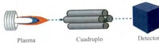
Figura 29. Esquema de Espectrómetro de Masas con Plasma Inductivamente acoplado, ICP-MS
